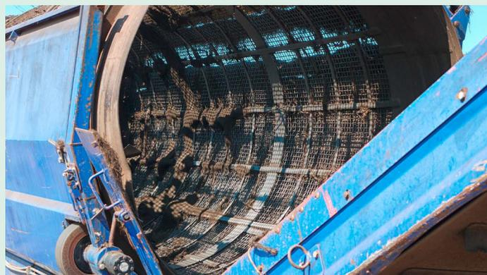
Maschinenpark, hier eine Maschine, die Material siebt.
