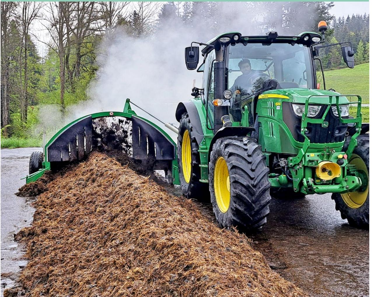
Hier ist eine Dreipunkt-Maschine mit einer Arbeitsbreite von 2,6 Metern zu sehen: Der Name rührt vom Aufnahmemechanismus: Zwei Unterlenkerpunkte und ein Oberlenkerpunkt dienen als Verbindungen zum Fahrzeugträger.
